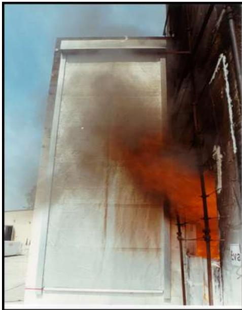
Brandversuch mit Feuerschutzvorhang zur Verhinderung einer Brandübertragung über Eck
