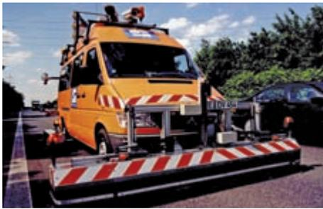
Abb. 1: Fahrzeug zur Messung der Längs- und Querebenheit sowie der Substanzmerkmale
