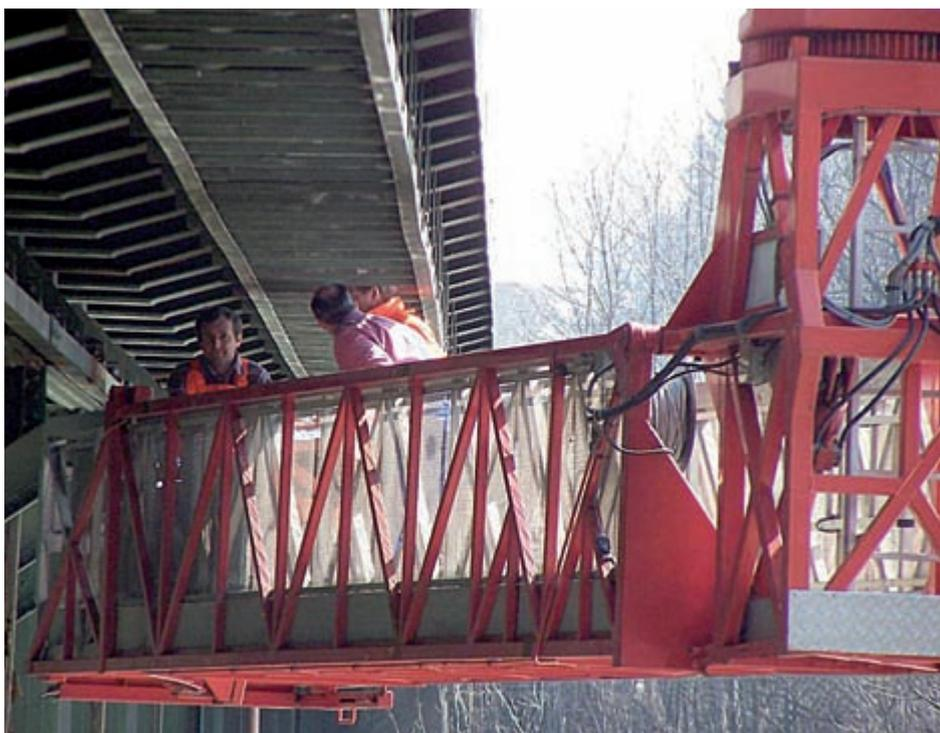
Abb. 3: Brückenprüfung mit Unterflurgerät
