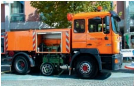
Abb. 2: Fahrzeug zur Messung der Griffigkeit
