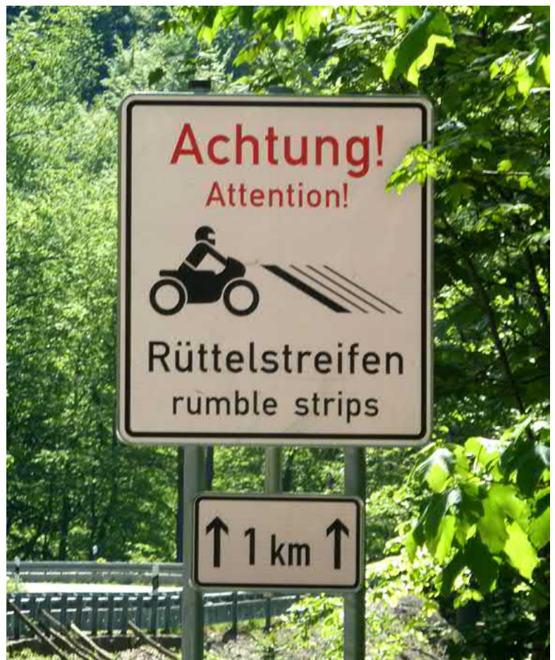
» Abb. 35 Hinweisbeschilderung vor den Rüttelstreifen auf der Bundesstraße B11 am Kesselberg (Abschnitt 200; Station 3,950)
